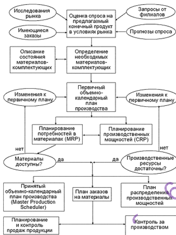
Рис. 1. Схематический план работы системы класса MRP II
