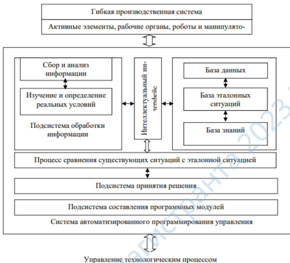
Рисунок 1. Архитектура системы автоматизированного программирования управления
